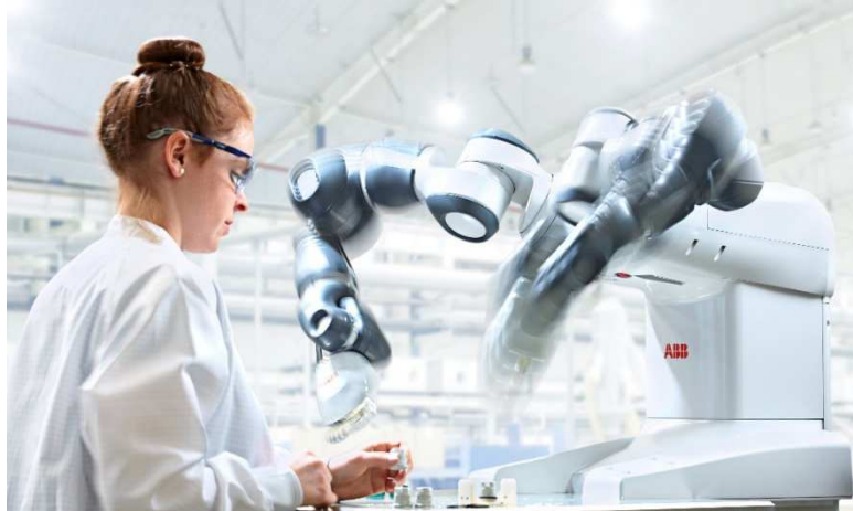
Ilustracija 34: Industrijski humanoid FRIDA razvijen kao koncept robot za novu generaciju hibridnih proizvodnih sistema koji počivaju na ekstenzivnoj fizičkoj i kognitivnoj interakciji čovjeka i robota (evropski FP7 projekat ROSETTA, sa fondom od 10 Mio EUR), prikazan gore levo. Goredesno, NexAge robot, proglašen za robota 2012. godine u Evropi (praktično primenjen u montaži AIRBUS A380 aviona). Slika dole: FRIDA robot transformisan u komercijalni proizvod kompanije ABB i plasiran 2015. godine na tržište pod nazivom YuMi, kao prvi dvoruki kolaborativni robot, kompatibilan sa specifičnim zahtevima koncepta Industrija 4.0. Roboti i drugi oblici automatizacije ne redukuju broj radnih mesta, oni ih pre transformišu!
