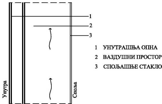
Сл. 1. Схематски приказ склопа двоструке фасаде
