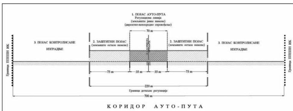
Slika 2: Šematski prikaz poprečnog profila koridora auto-puta
