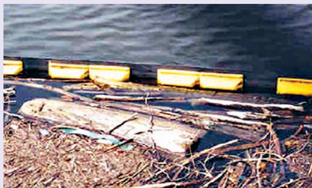
Сл. 6. Детаљ-прикупљање отпада на пластичној баржи Picture 6. Detail – Collecting the waste using plastic barge
