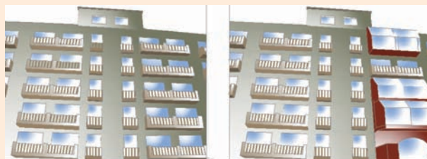
Сл. 12. Постојеће стање(а) и могуће интервенције на јужној фасади(б) Fig. 12. Current state (a) and possible interventions on the southern face (b)
