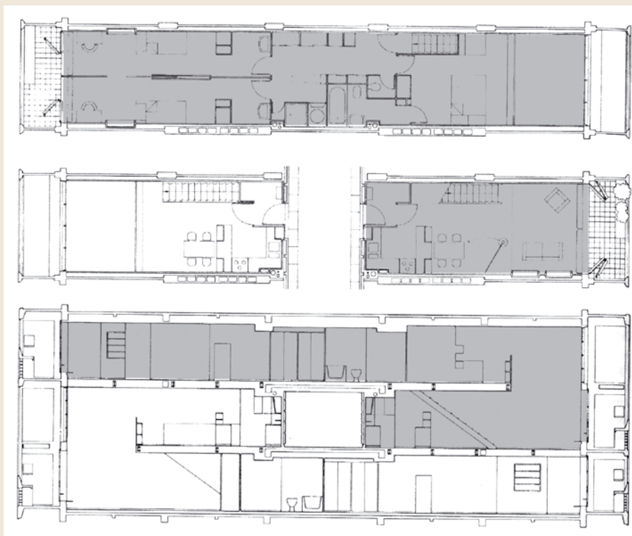
Сл.15. Стамбени блок у Марсеју – основа типског стана и попечни пресек Fig. 15. Unité d'habitation in Marseille – plan of the typi- cal unit and a cross section
