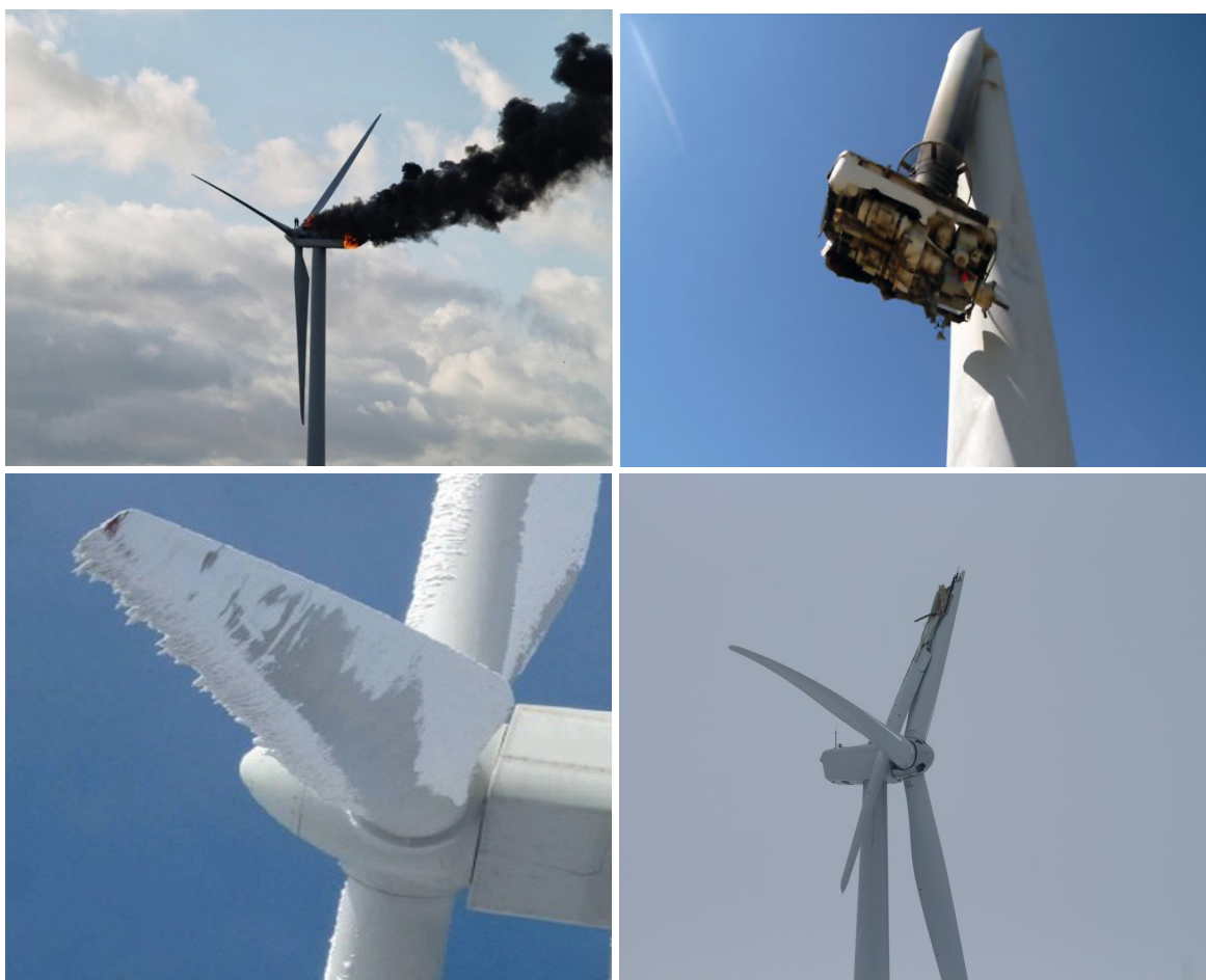
Slika 30. Mogući akcidenti na vetroagregatima (požar: gore-levo; udar groma i prelom stuba: gore-desno; led na elisama: dole-levo; prelom elise: dole-desno) (Izvor: PEI, 2017).
